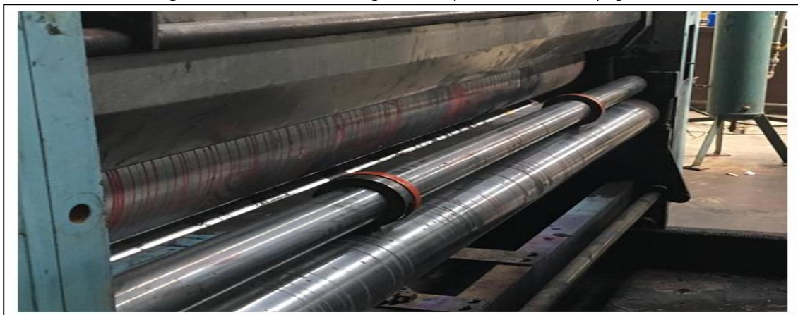
Figura 17 - Resíduo de tinta gerado no processo de estampagem.
