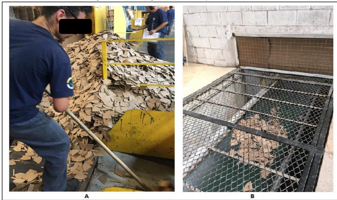
Figura 12 - Rastelagem de descarte para a esteira.
