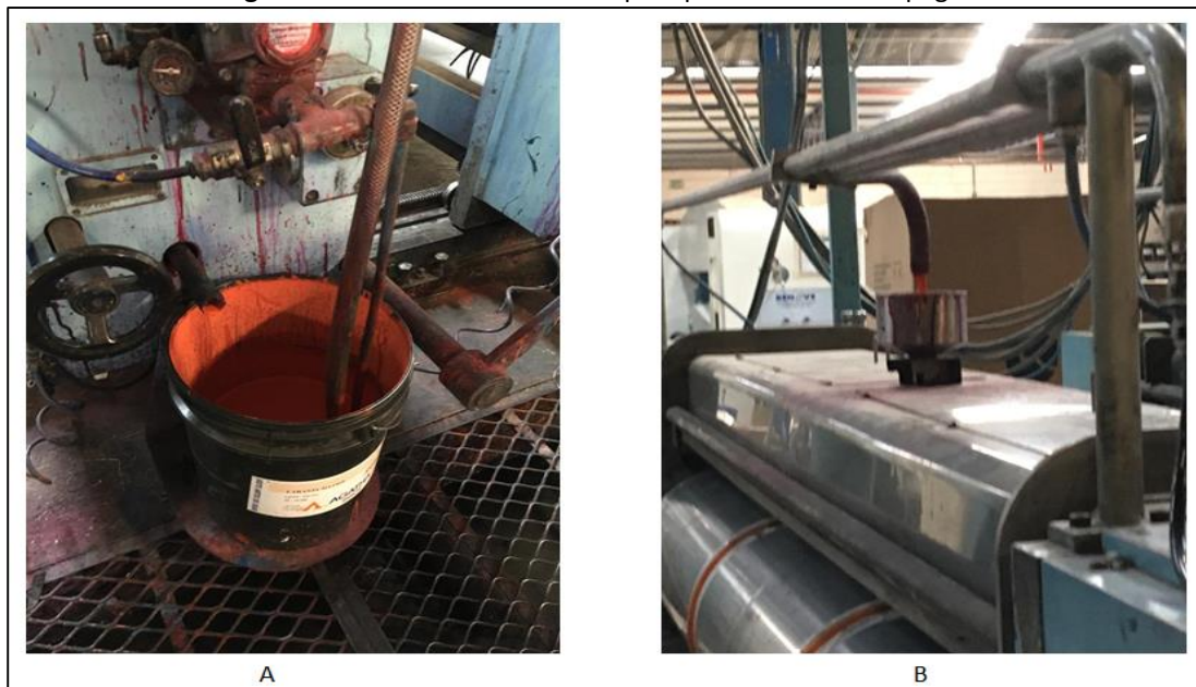
Figura 16 -Tinta em transferência para processo de estampagem.
