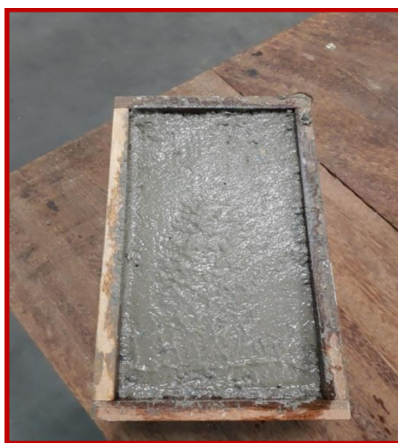
Figura 13. Forma com traço de concreto com plástico granulado.
