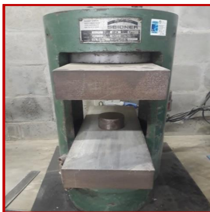
Figura 16. Prensa para teste de resistência à compressão.
