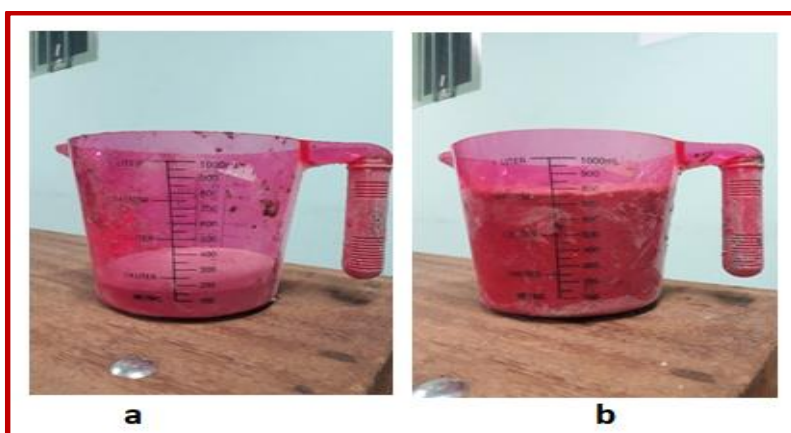
Figura 11. Recipiente com 150 ml de cimento (a), 750 ml areia média (b).
