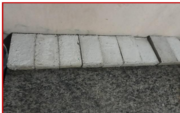
Figura 15. Corpos de prova desenformados.
