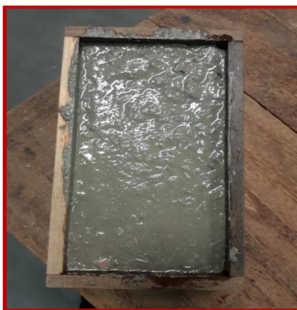
Figura 10. Forma com traço de concreto com plástico triturado.
