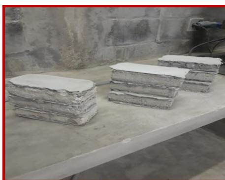
Figura 17. Corpos de prova nivelados com concreto magro.
