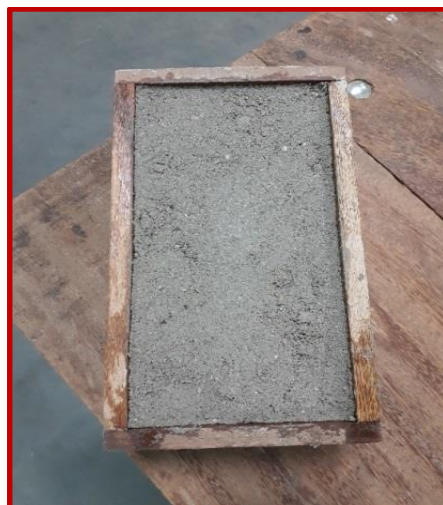
Figura 7. Forma com traço de concreto puro.
