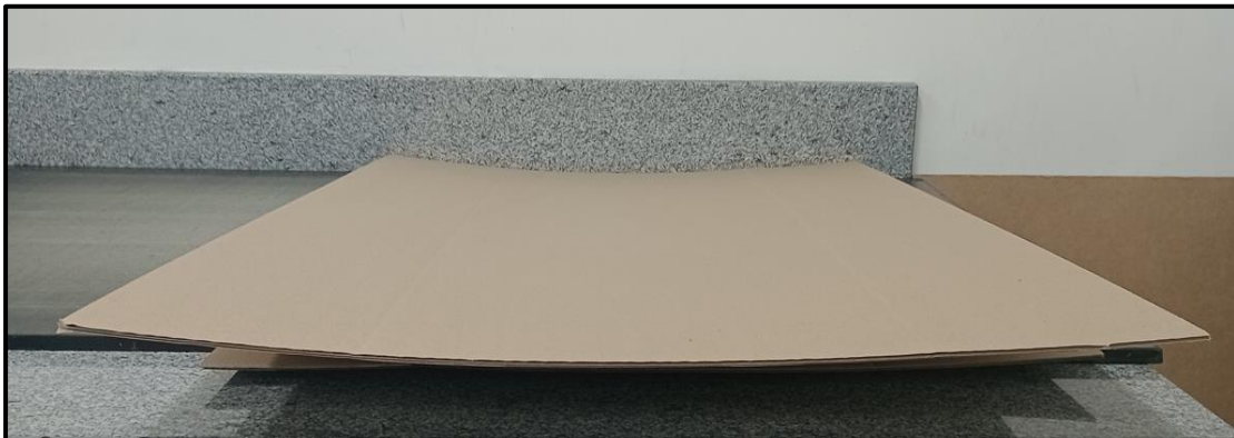
Figura 1 - Chapa apresentando empenamento
