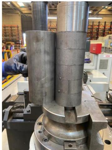
Figura 4.10. Calços utilizados para fixação da roldana.
