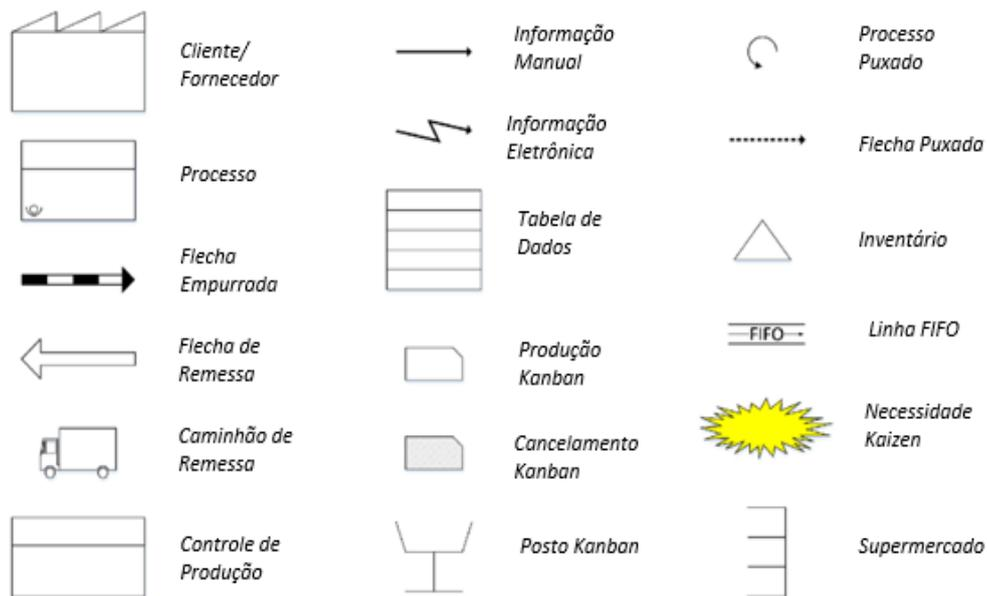
Figura 2.11: Ícones usados para mapeamento de fluxo de valor
