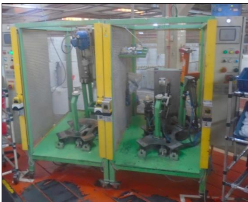
Figura 10. Máquina de teste de estanqueidade à esquerda e de solda à direita.
